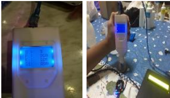
Gambar 6. Keragaan Prototipe Perangkat Uji Tanah Sawah Digital untuk Tanaman Pangan
