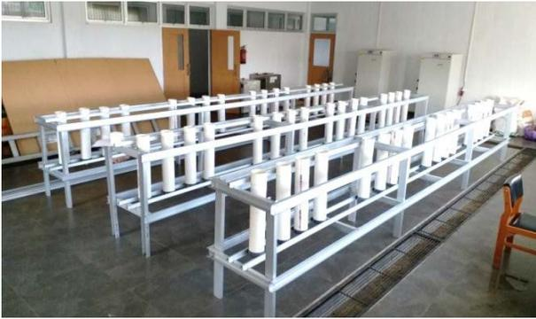
Gambar 5.95 Susunan penelitian pencucian unsur hara dan karbon di laboratorium
