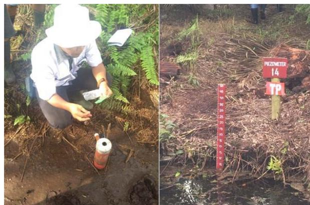
Gambar 4.32. Pengukuran tinggi muka air pada titik pengamatan dan pada saluran drainase masih dilakukan secara manual
