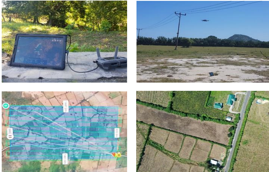
Gambar 16. Pemantauan jalur terbang drone melalui tablet dan remote control (a), Saat Pendaratan Drone di Lahan Penggembalaan Desa Senayan (b), Jalur Terbang Survey Foto Udara Lokasi Desa Senayan (c), Citra Foto Kawasan Balai Benih Induk (BBI) pada Ketinggian 200 m (d)
