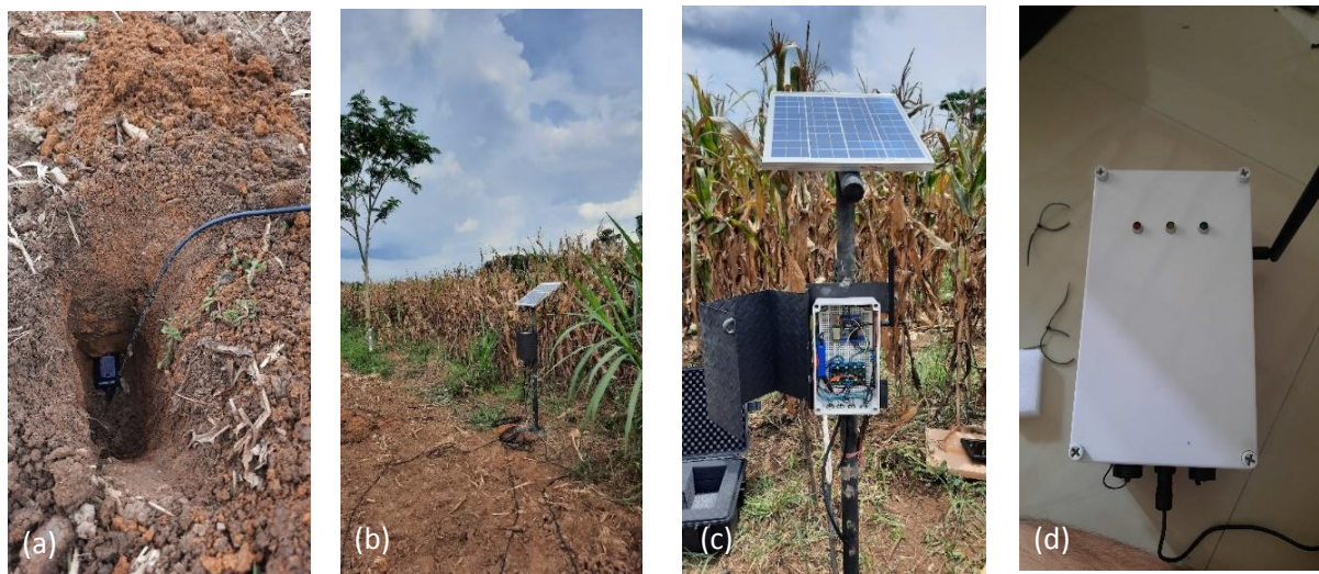
Gambar 10. Instalasi Sistem Monitoring Kelengasan Tanah di lokasi Demfarm LKM Desa Karang Rejo, Kecamatan Jati Agung, Kabupaten Lampung Selatan: (a) sensor kelengasan tanah terkubur di kedalaman 20 cm; (b) dan (c) Node dengan tenaga panel surya yang terhubung sensor; (d) Gateway yang menerima data dari Node lalu mengirimkan dan menyimpannya kedalam cloud melalui jaringan internet.
